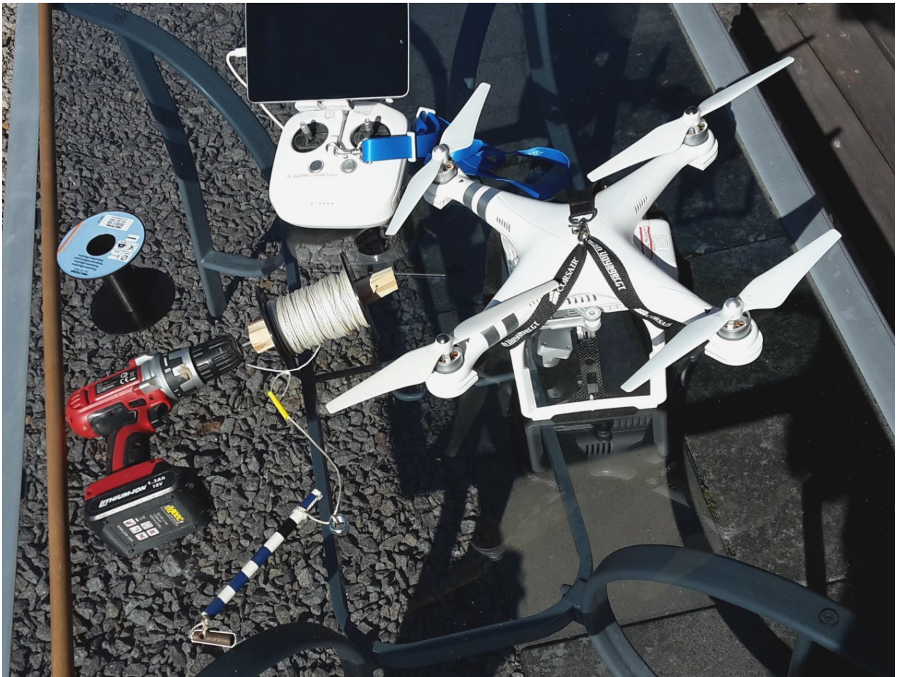
Bild 1. Utrustning för "drönarmetoden" att sätta upp longwire-antenn. Drönare och fjärrkontroll, lång tunn lina med väl synlig tyngd (randig) i änden och ev en uppvindare för linan. Den långa stören på 4+ m eller båtshaken har man nytta av om en lina fastnat i en gren.
