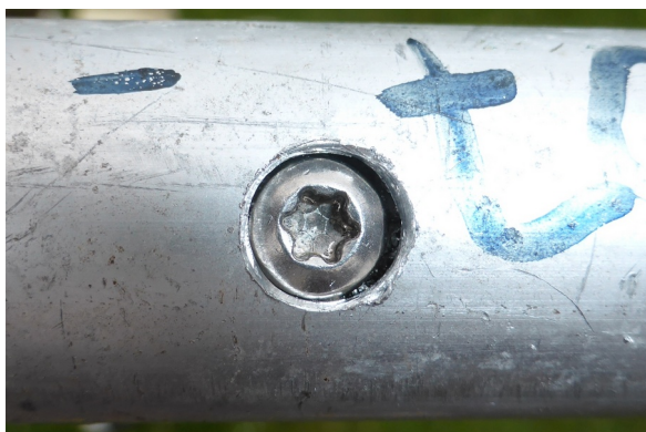
Bild 4 – Nersänkt skruv för skarvning av rör som inte passar tajt.
