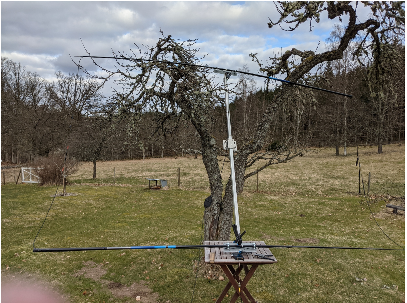
Bild 6 - Exempel på trimning av experiment-Moxon-antenn modell "fiskspön" med NanoVNA. Radiator uppåt.
