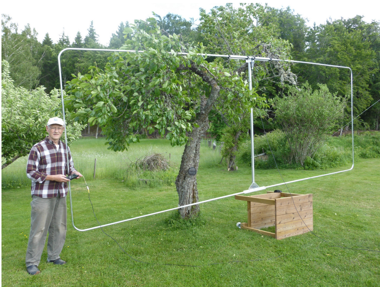
Bild 5 – Moxon Rectangle för 17m-bandet i 20/25 mm alu-rör, klar för mätning innan uppsättning. Reflektor neråt. (Samma träd som i bild 6!)
