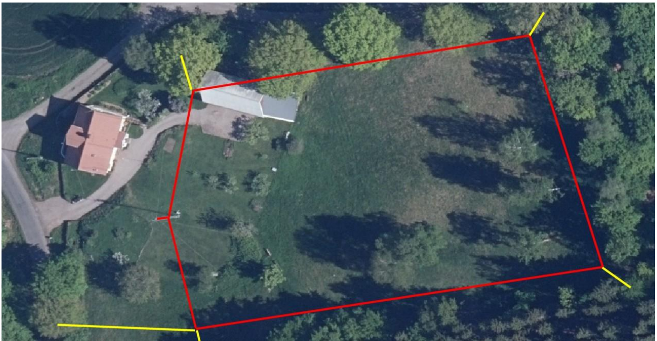
Bild 9. SA7CND "Big HF Loop" för alla HF-band, 333 m lång, i rött. Bärlinorna är markerade med gult och slutar i linhjul för antenntråden.
