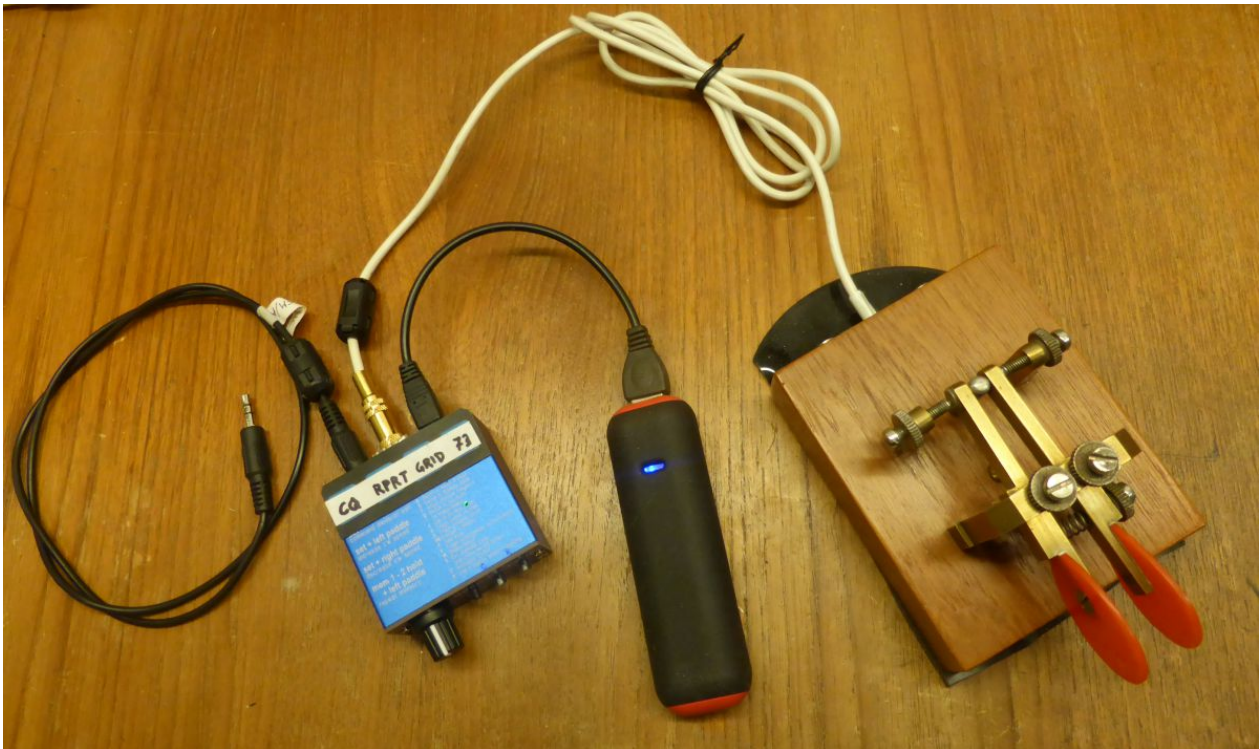
Bild 3. Min (modifierade) Open CW keyer Mk2 med en powerbank. Keyerns yttermått är 57x55 mm.
