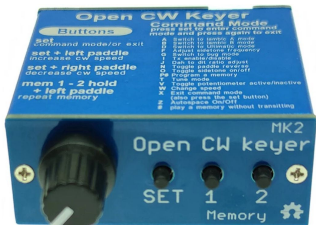
Bild 1 - Frontpanel med CW-hastighet, SET för kommandon och minnesknappar 1 och 2.
